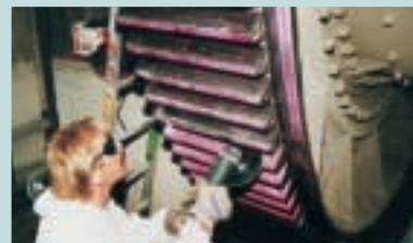
Überarbeitung von Tragflanken. Treatment of the working tooth flanks.
