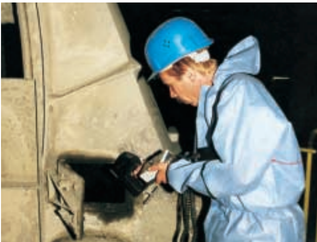
Dynamische Tragbildkontrolle mit Stroboskop. Dynamic checking of the contact pattern with a stroboscope.
