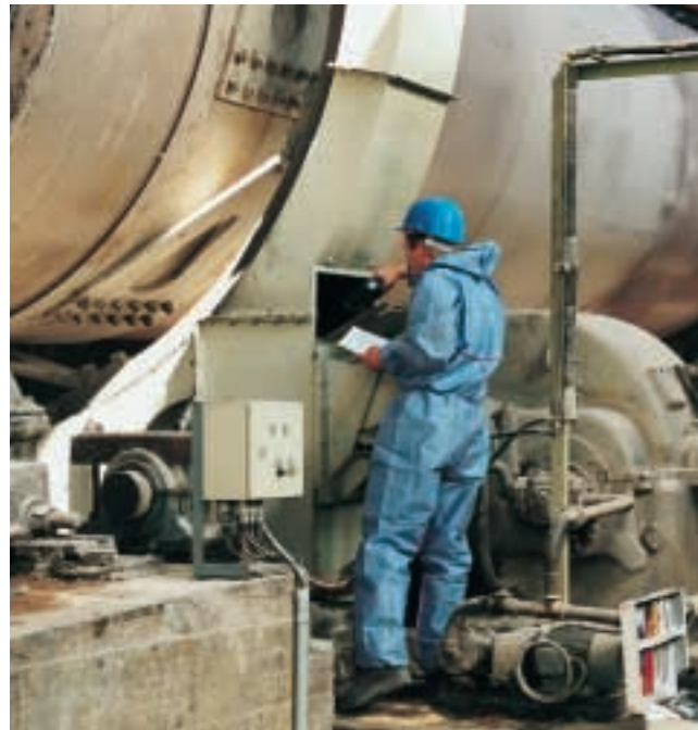
Berührungsfreie Temperaturmessung mit einem IR-Thermometer. Contactless temperature measurement with an IR thermometer.
