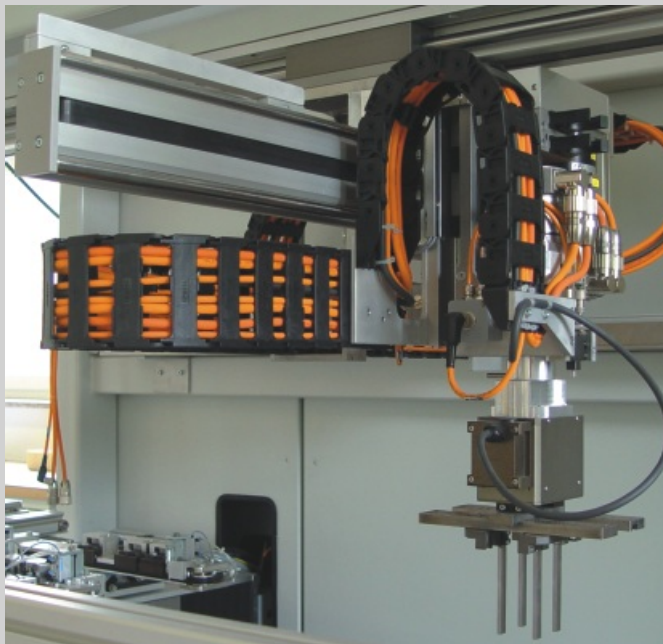
2-Achs-Positioniersystem mit Greiferapplikation, Modul 105 2-axis-positioning system with gripper application, Module 105
