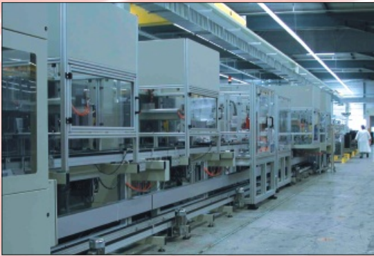
Montage verschiedener Bau- gruppen mit Transfertechnik Mounting of different compo- nents with transfer technology
