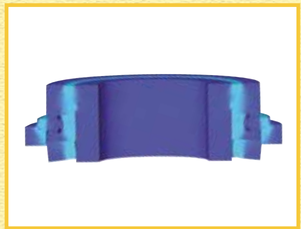
4 Stato tensionale con ralla di supporto Static nodal stress with thrust washer
