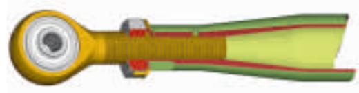
Trou de contrôle sur corps de bielles Inspection hole on the rod body
